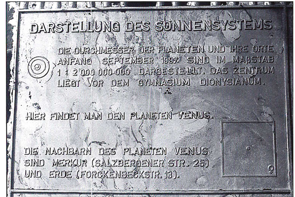
Das Foto zeigt die frisch ihrer Gußform entnommene, unbearbeitete „Sternengarten“-Platte für den Planeten Venus. Nach der Beseitigung der Gießrückstände an den Plattenkanten poliert und färbt der Gießer die Bronzetafel.
